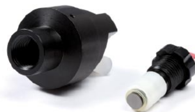
Abb. 2: Reaktorzelle mit Inlet und Outlet (links) sowie Elektrodenhalter mit verschiedenen Arbeitselektroden (rechts)
