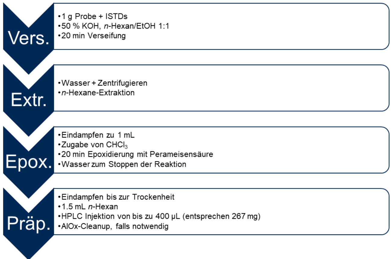
Abbildung 6: Automatischer Workflow für die Analyse von MOSH/MOAH in Speiseölen und -fetten
