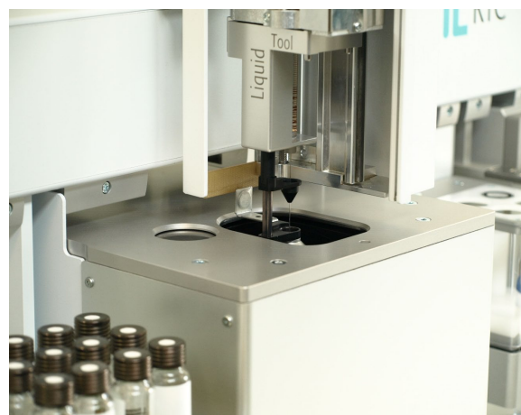
Abbildung 3: Zentrifuge als Teil der automatischen Epoxidierung.
