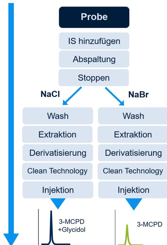
**Abbildung 1:** Schematische Darstellung der Probenvorbereitung für die indirekte MCPD-Analytik mit der „DGF Fast & Clean“ von Axel Semrau - automatisiert mit der CHRONECT Workstation MCPD.
